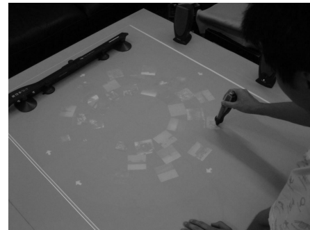
図 15. ペン型デバイスによる仮想回転卓操作
