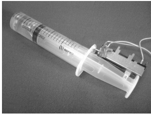
図 4. 水の量の測定モジュール. 注射器のピストン押しこみ量を読みとることができる.
