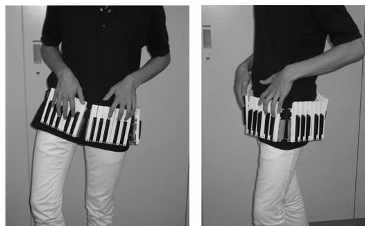
図 4. 環状接続したユニット鍵盤の装着
