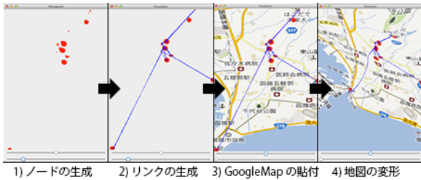
図 2. 行動マップ生成システムの作成の流れ
