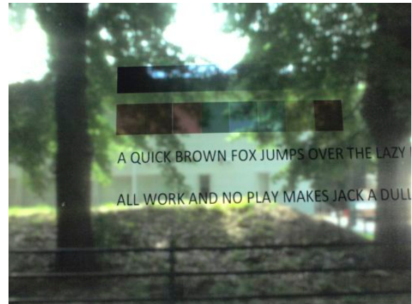
図 7. 透明液晶を利用した窓の試作例
