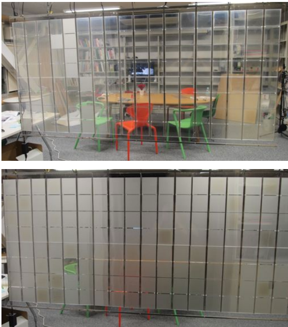
図 1. Squama: モジュラーに透明度を制御できるプログラマブル建築のための窓/壁. “phygcell” と呼ぶ矩形単位で光の透過性を変化させることができる.
