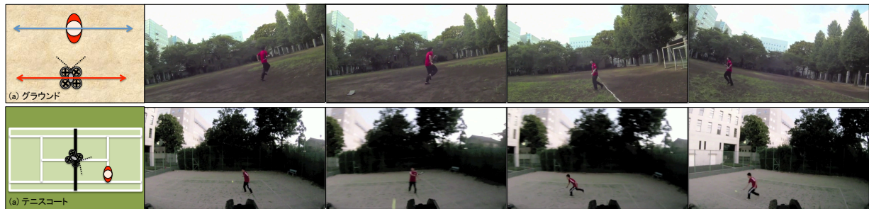
図 7. スポーツシーンのクアッドコプタによる撮影 (a) 走る対象を横から並走して撮影 (b) テニスコートのセンターネット上に静止してプレイヤーを撮影
