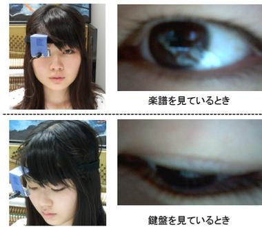
図 3. 視線認識用カメラの装着
