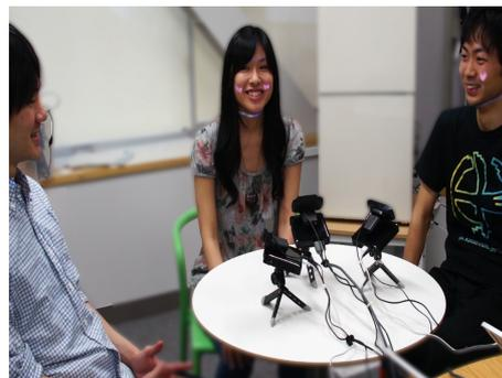
図 1. BrightFace システム。ユーザの表情を検出し、それに応じたアイコンをプロジェクションする。
