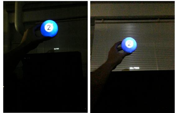
図 5. キャリブレーションによる位置合わせ.(左) と (右) は位置が 1m ほど離れているが, 球の形状に沿った映像が投影される.
