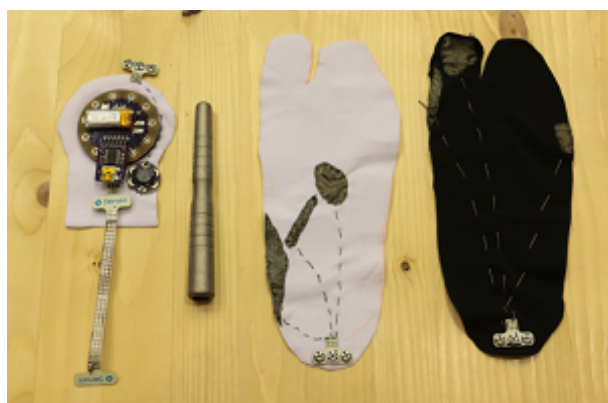
図 3. ソックス型プロトタイプの外観. 左から, LilyPad シート, チタン製指圧棒, 症状別足つぼシート (白: 疲労回復用, 黒: 頭痛改善用)
