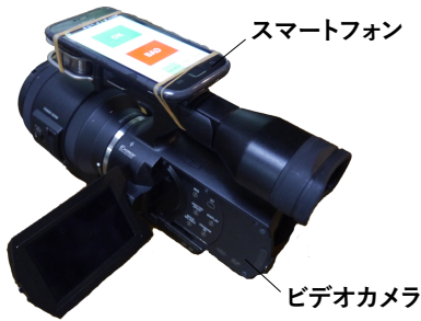
図 3. AnnoTone 使用時のハードウェア構成の例
