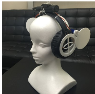
図 2. 開放度をより高めた機構を備えたプロトタイプ2号。
