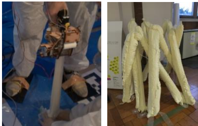
図 3. 発砲ウレタン材の棒材. 左は製作途中, 右は固まった状態
