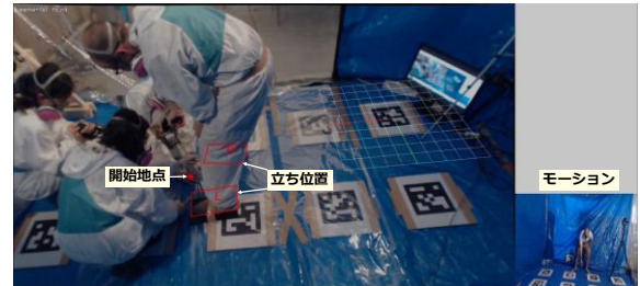
図 7. AR による作業指示システムの概要図（上）と UI（下）。UI の右下にモーションを指示する動画がある。
