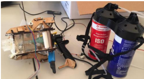
図 9. 工具。左の工具がスプレーの本体となり、右のスプレー缶は発泡ウレタン材となる。スプレーの先にメッシュを出す装置がついている。
