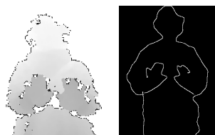
(a)濃淡画像 (b)エッジ検出画像 図 2. エッジ検出処理画像
