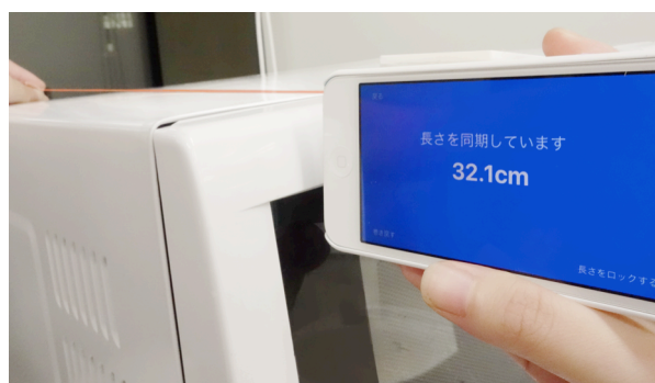
図 2. ロープで長さを測るとその長さが自動で共有される。例えば、このように電子レンジの奥行きを測ると、他者の SyncRope がロープを同じ長さに出力する。
