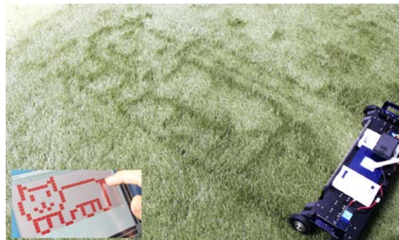
図 1. ローラー型装置で人工芝面に描画をしている様子
