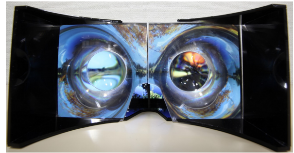
図1. プロトタイプ全体写真。プロトタイプは2枚の凸レンズと周囲にそれぞれ2枚のフレネルレンズを備える。写真中の凸レンズ周囲の映像が強く歪んでいる領域がフレネルレンズ部分である。
