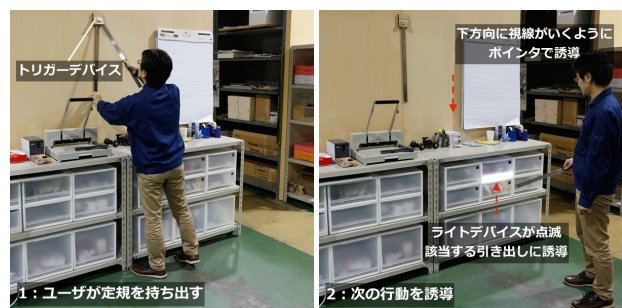
図 1. 定規が持ち出されたことを検知し(左図), カッターが収納された引き出しを示す(右図)。
