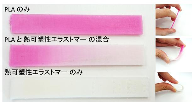
図 2. PLA と熱可塑性エラストマーを用いた作成例
