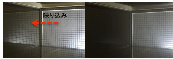
図 8. 側面への映り込みと偏光による対策
