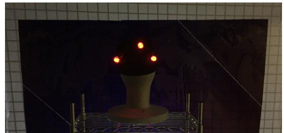
図 11. 右円偏光シートを貼ったプール前面と右円偏光を通さないフィルターを通したヘッドトラッキング
