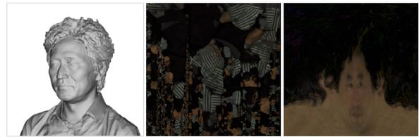
図 2. 撮像された三次元顔形状 (左) およびテクスチャ画像 (中). (右) はテクスチャが連続するように再配置したもの。
