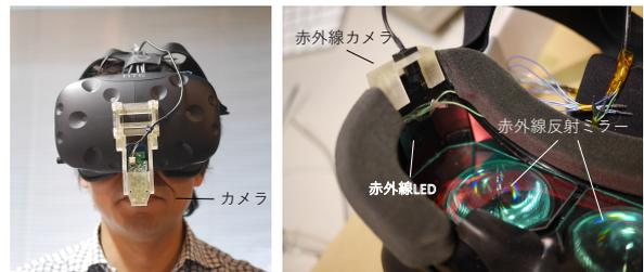
図 3. 顔画像取得のためのカメラと赤外線反射ミラー
