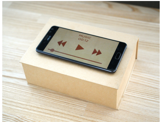
図 6 UI としての利用: ユーザが制作したスピーカーの筐体に UI としてスマートフォンを設置し操作する
