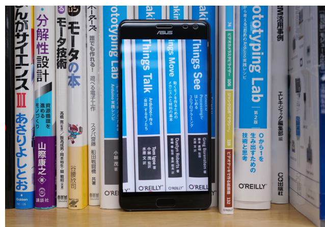
図 1. 本手法を実際に使用した例: 本棚に設置したスマートフォンにテクスチャが自動で周囲に合わせて表示される
