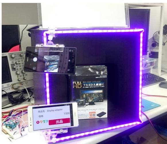
図2. 実装した販売ボックスのプロトタイプ. 左上に撮影と画像認識用のカメラ, 左下に値札ディスプレイを備える. 左奥は制御用の回路で, LEDは点灯中.
