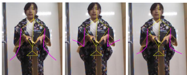
図 3. ダミーアーム(図中のマゼンタの線). 裾丈を決めるステップの様子.
