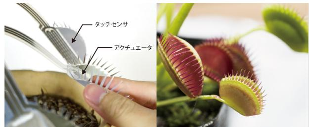
図 8. ハエトリソウ型インタフェース。電熱パターン、配線、タッチセンサが一括印刷されたフィルムの上にアクチュエータが乗っており、指を乗せると葉が閉じる
