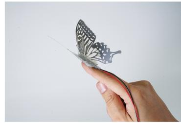
図 7. チョウ型ロボット。背中に電熱パターンが印刷されており、その上にパウチが貼り付けられている
