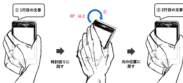
図 7. iPhone本体を時計回りに30°以上回転させると次の1行を選択する
