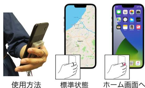
図1. 本研究で開発したデバイスの概要。スマホリング型のデバイスに人差し指でダブルタップのジェスチャ入力を行うことで、地図アプリからホーム画面へと移動している様子。
