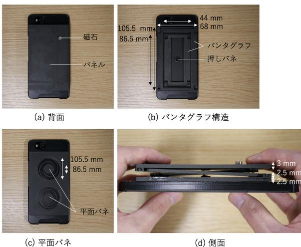
図5. 改良版のプロトタイプ実装の概観
