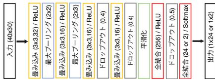
図 5. CNN の層構造
