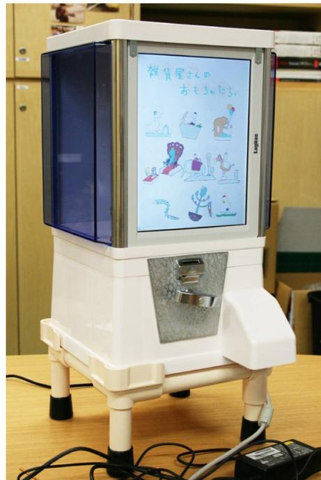
図 1. ガチャガチャ本体に液晶ディスプレイを組み込んだ様子
