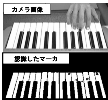
図 8. カメラから取得した画像と画像処理結果
