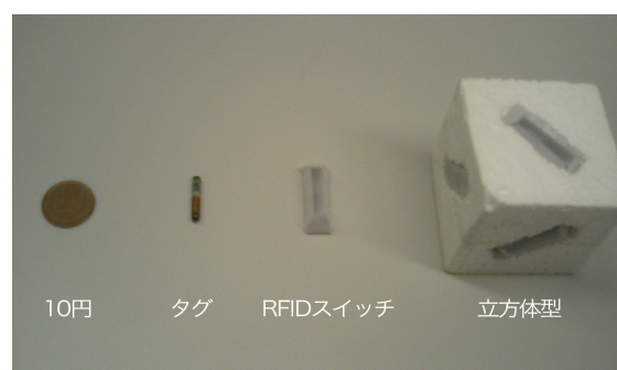
図 2. タグ、回転方式スイッチ、立方体への埋め込み
