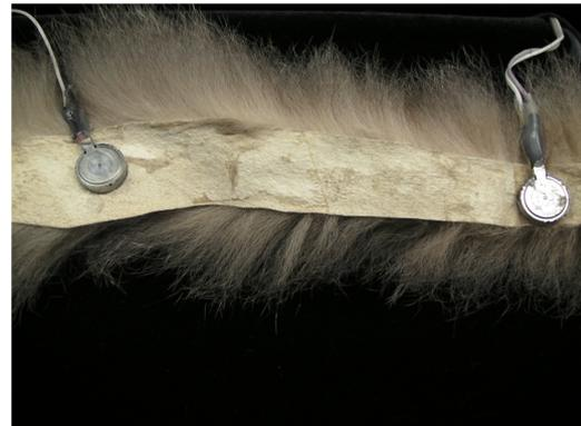
図 4. Fur に振動モータが装着されている図
