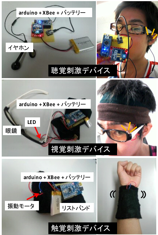
図 3. デバイスのプロトタイプ
