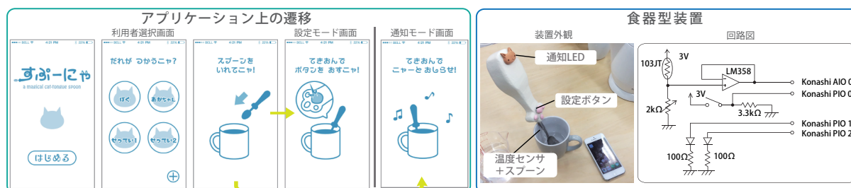
図 1. 左：アプリケーション上の遷移 右：食器型装置の外観と回路図
