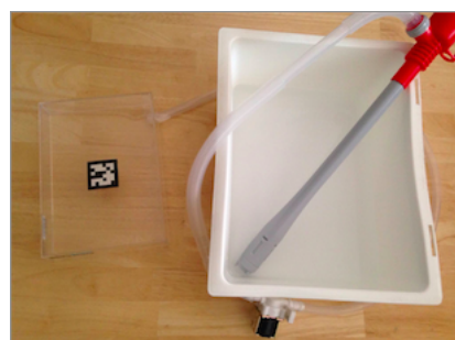
図 3. 水の供給に用いられる, タンク, ポンプ, ソレノイド弁, ホース
