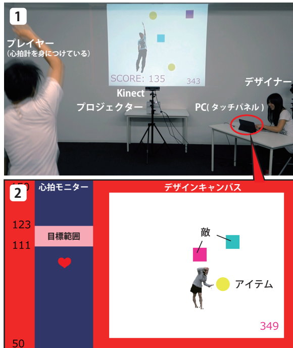
図 2. (1) システム構成図。プレイヤーは心拍センサを身につけた状態で体を動かしてアイテムを取ったり敵から逃げたりする。(2) デザイナー画面。デザイナーはプレイヤーの心拍数が目標範囲に入るように画面をタップしてアイテムを配置したり、スワイプして敵を動かしたりする。
