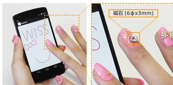
図 1. マグネイル：磁石を含んだネイルアート。マグネイルの動きに合わせてモード切り替えを行う。
