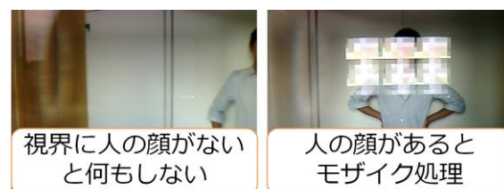
図 5. モザイク機能. HMD のディスプレイ領域全体にモザイクを重畳表示し、コミュニケーション相手の顔を隠す。
