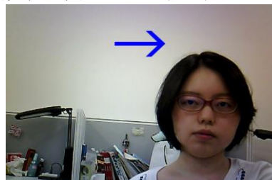
図 3. 行動改善機能のコンセプト図。シースルー型 HMD 上に矢印を表示することで視線移動を促し、対人コミュニケーション相手とのアイコンタクト成立を支援する。この例では相手の顔のある右方向へと視線を移すことを促している。
