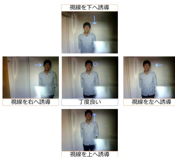
図 7. 行動補正機能. コミュニケーション相手の顔が視界の中央にくるように矢印を重畳表示する. 実際の視界上の重畳位置と本写真との間にはややズレがあることに留意されたい.
