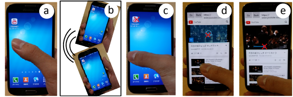
図 6. 動画サイトへのアクセスおよび動画の再生. a: 指が直接届かない領域に表示された動画サイトのアイコン. b: シェイク動作による TouchOver の起動. c: TouchOver を用いたアイコンのタップ. d: TouchOver を用いた再生ボタンのタップ. e: TouchOver を用いたシークバーの操作。
