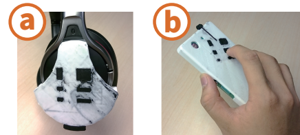
図 9: MonoTouch の適用例 (a: ヘッドホンカバー, b: スマートフォンケース)
