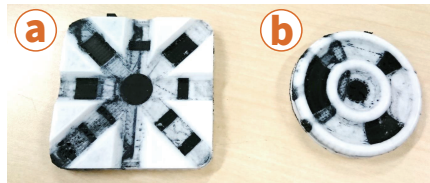
図 10: 溝を付与した電極形状 (a: 8 方向スワイプ検出用電極, b: 回転ジェスチャ検出用電極)
