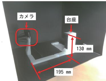
図 7. 実験に用いた台座および箱
