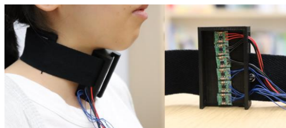
図 1. 喉頭位置計測装置の装着様子とその外観
