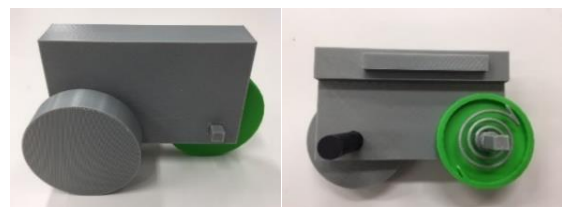
図 4. 作成したプルバックカー (左) と内部構造 (右)
