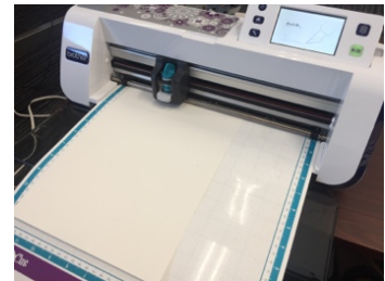
(b)自動生成された型紙 (c)カッティングプロッタで切断する様子
