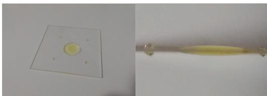
図 8. 両凸レンズの造形例とその断面
