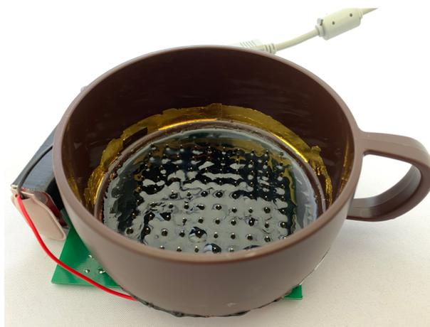
図 1. BubBowl. 電解液を入れる前の状態である。マトリクス陰極群と共通陽極が容器内部に配置されている。
