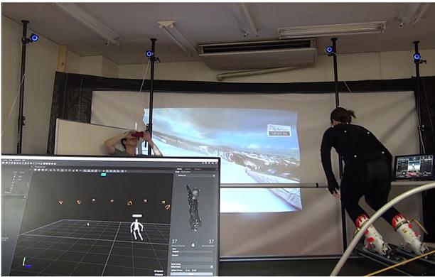
図 2: 熟練者のモーションを捕捉する様子. OptiTrack システムを使用して 8 台のカメラから撮影している。
