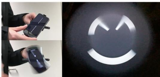
図 6. 利用例。ケースにスマートフォンを装着／回転させることで残像表示を行う。
