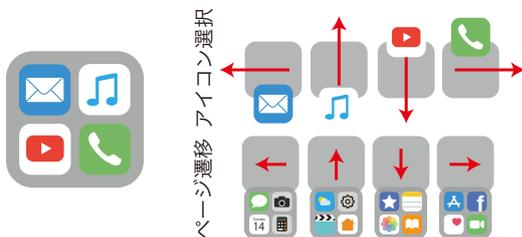
図5. アイコンフォルダに対するショートカット。フリックによってアイコン選択, 提案操作によってフォルダのページ遷移が可能である。
