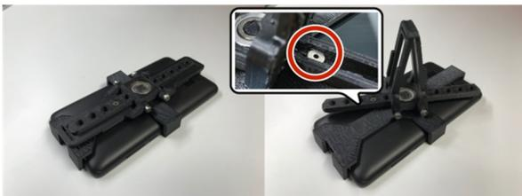
図 5. 改良型回転ユニットの外観と利用時の変形の様子／磁石の位置(丸)
