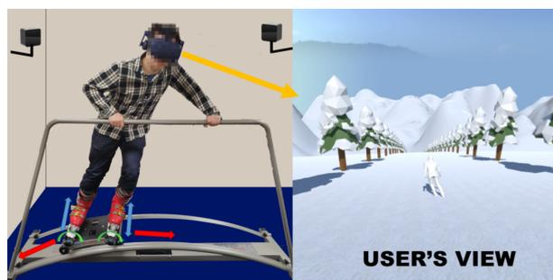
図 1: システムの概要図. ユーザは HMD を通して右図のスキー空間を見ることができる.
