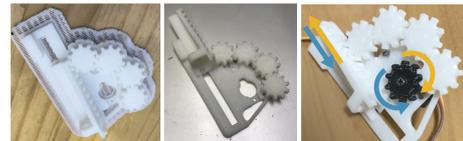
図 7. サーボスライド. 左: サポート材除去前, 中央: サポート材除去後, 右: サーボの回転方向とスライダの移動方向.
