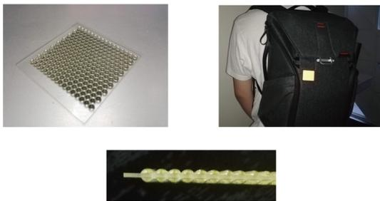
図 12. 反射板（左上）とその断面（下），靴に取り付けて光を当てた様子（右上）
