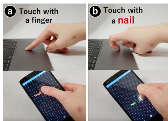
図 1. タッチサーフェス上での (a) 従来の指によるタッチ入力および、(b) 本論文で提案する爪を介したタッチ入力 (ScraTouch)。指の皮膚と爪の電気的特性の差異より 2 種類の接触部位を識別し、タッチ入力を拡張する。
