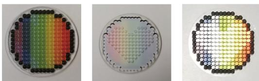
図 13. 自由にデザインした反射板（左）。一部を片面のみの造形（中央）とすることで、光を当てた際に両面造形部分が浮かび上がる（右）。
