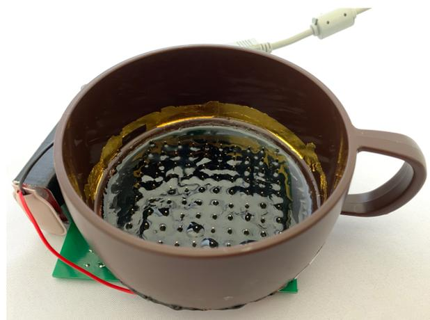
図 1. BubBowl. 電解液を入れる前の状態である。マトリクス陰極群と共通陽極が容器内部に配置されている。
