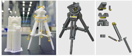
図 9. プチ三脚. 左: サポート除去前／除去後の外観, 中央: モデル外観, 右: 主要部品と回転機構
