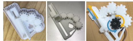
図 7. サーボスライド. 左: サポート材除去前, 中央: サポート材除去後, 右: サーボの回転方向とスライダの移動方向.
