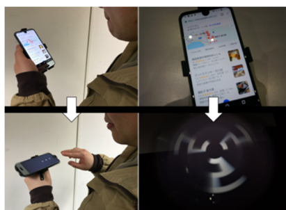
図 1. 本システムの概要. スマートフォンに回転機構ユニットを一体化することで、通常状態 (上) と回転時の残像ディスプレイ状態 (下) を併用した新たなインタラクションを目指す。
