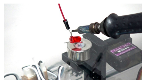
図 10 磁力で固定しはんだごてをしている様子
