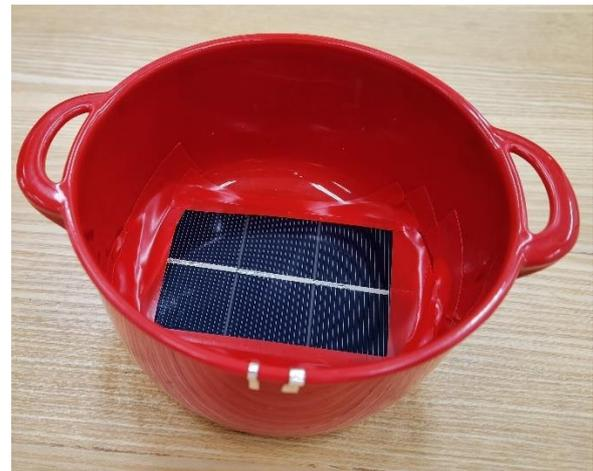
図4: 太陽電池をカップの底に上向きに配した装置.
