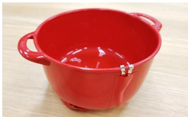
図 1: 上方から見た提案装置。口元の 2 枚の銀板が電極である。
