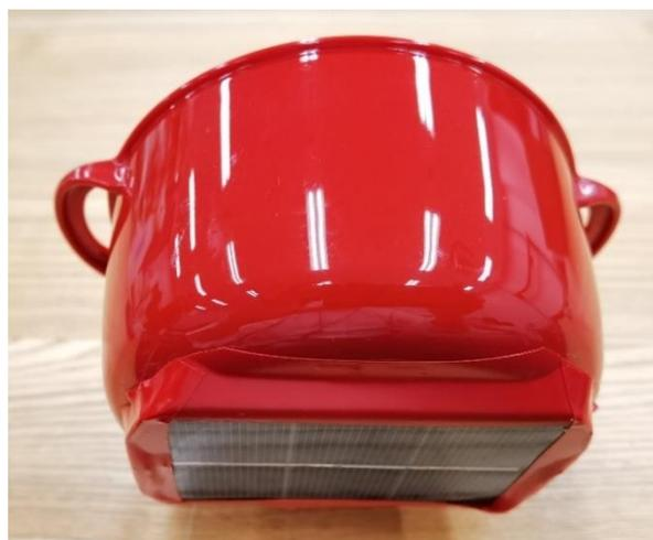
図 2: 下方から見た提案装置。カップの底は太陽電池である。
