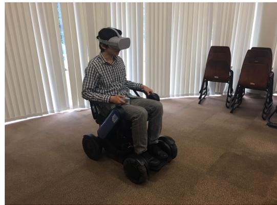
図 1. HMD と電動車椅子を用いた車椅子シミュレータの外観
